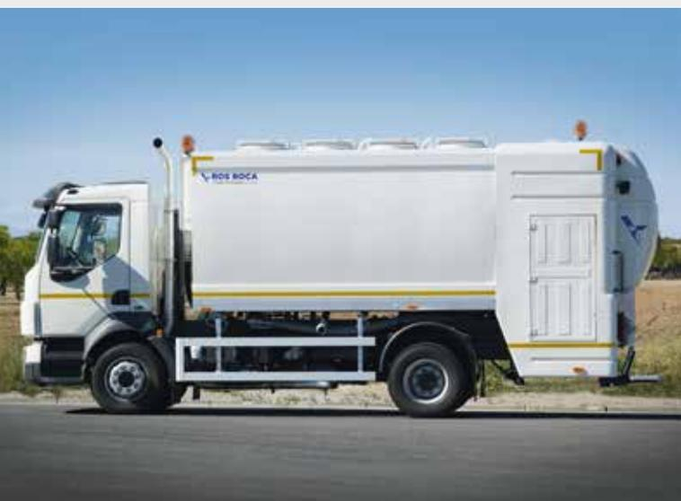
El lavacontenedor en agua fría realiza la limpieza interior y exterior de cubos y contenedores. Permite lavar indistintamente cubos de 80 a 390 litros con perfil de carga frontal mediante peine, contenedores de 500 a 1.200 litros tapa plana y contenedores de 770 a 1.300 litros mediante peine o brazos mecánicos.
