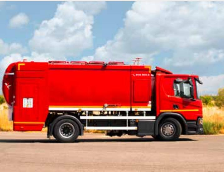
Los lavacontenedores de agua caliente realizan la limpieza interior y exterior de cubos y contenedores. Permiten lavar indistintamente cubos de 80 a 390 litros con perfil de carga frontal mediante peine, contenedores de 500 a 1.200 litros tapa plana y contenedores de 770 a 1.300 litros mediante peine o brazos mecánicos.
