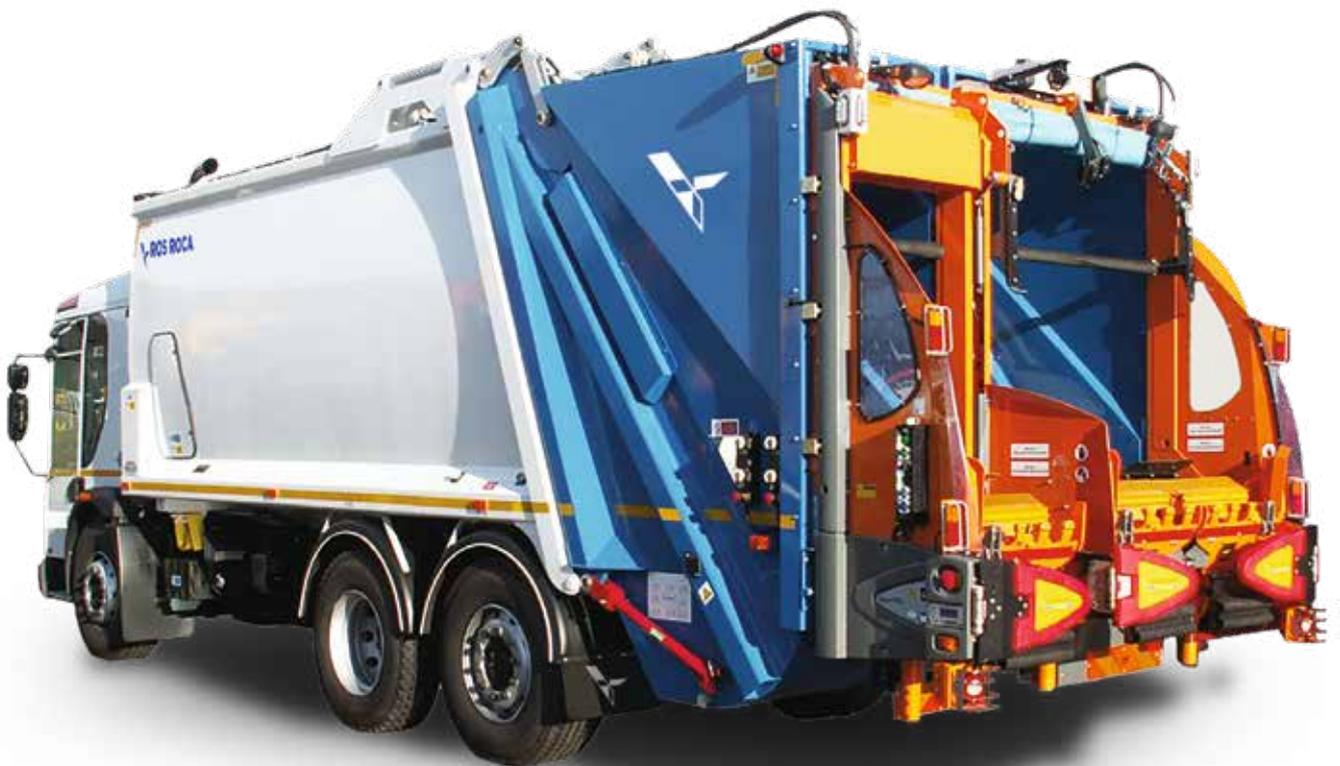
Con dos compartimentos independientes, con sus respectivas compuertas traseras y sistemas operativos, el Olympus Twin Pack permite la recogida de dos tipos de fracciones o residuos distintos al mismo tiempo, por lo que los desechos residuales y los reciclables (vidrio, plástico, papel o cartón) pueden recogerse dos a la vez en una misma ruta.
