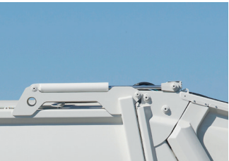
4 Cilindros de elevación de la tolva en techo protegidos.
