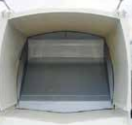
1 Placa eyectora pasante ajustada a la caja.
