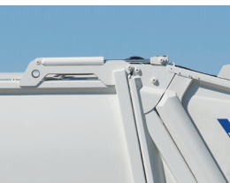
4 Cilindros de elevación de la tolva en techo.
