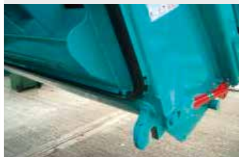
5 Junta de estanqueidad Bio hasta el techo.
